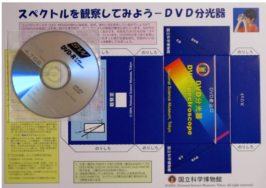
Fig. 1 分光器の組立キット(DVD-Rが付属している)
