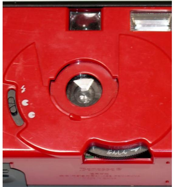
Fig. 3 「ぶんしん」モードの状態:プリズムが撮影レンズの前に配置されている
