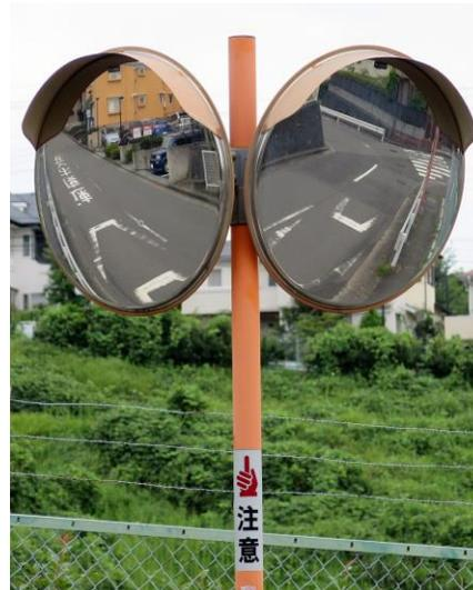
Fig. 6 道路に設置された凸面鏡 (カーブミラー)
