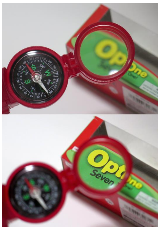
Fig. 2 コンパスの外観とルーペとしての利用(ルーペ枠/遠方の拡大像にピントを合わせ撮影)
