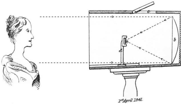
Fig. 1 凹面鏡を用いるカメラ1)
