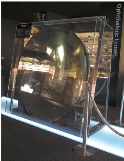
Fig. 3 大型探照灯用の凹面鏡(写真撮影: 著者)
