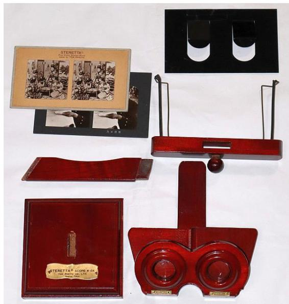
Fig. 2 ステレオスコープを分解した様子
