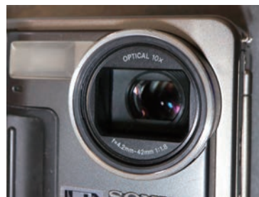
Fig. 4 折り曲げプリズムと撮影レンズの外観 【SONY Digital Mavica MVC-FD7】
