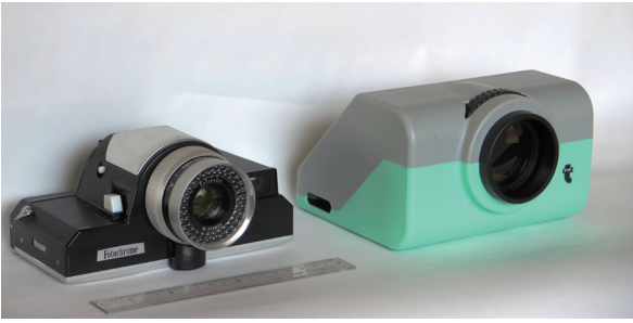
Fig. 1 屈曲光学系を用いたカメラとプロジェクター
