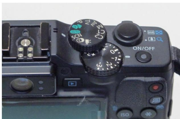
Fig. 3 コンパクトデジタルカメラの露出補正ダイヤル
